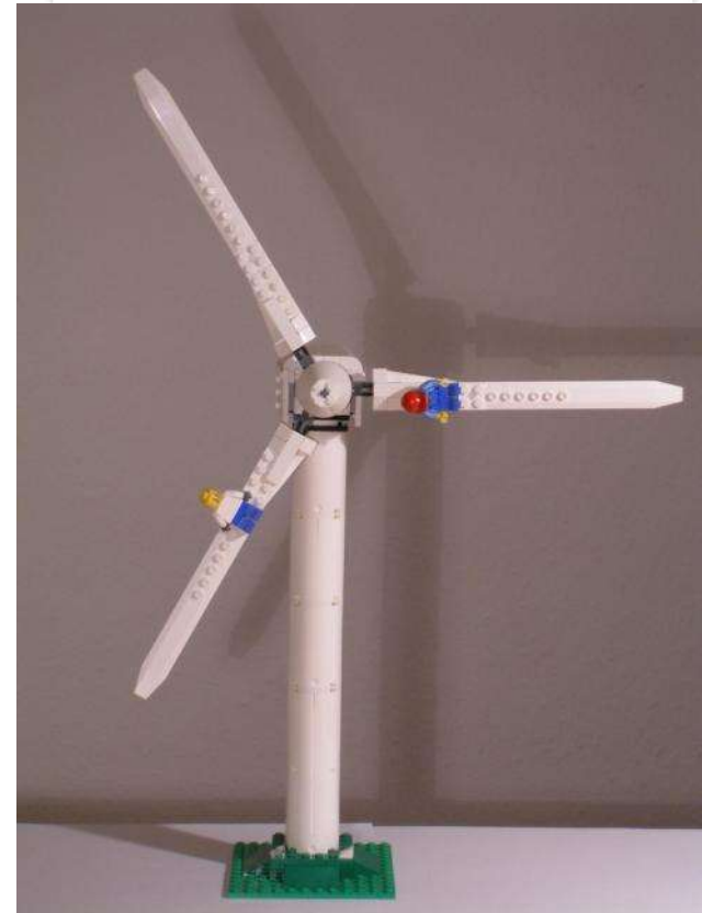
WEA mit AU und MU: Verschiedene Massen und – verteilung sowie unter- schiedliche Aerodynamik
