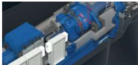
Messpunkte am Gondelrahmen (MP5), am Generator (MP4,3), am Getriebe (MP2) und am Hauptlager (MP1)
