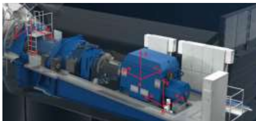
Messpunkte am Gondelrahmen (MP5), am Generator (MP4,3), am Getriebe (MP2) und am Hauptlager (MP1)
